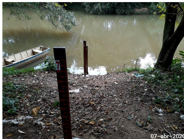
Foto 16 – Detalhe das régua limnimétrica após a manutenção no PHJ - 7°C (Data: 07/04/20).
