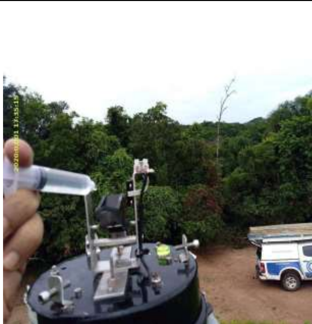
Foto 7 - Cone do Pluviômetro Limpo
