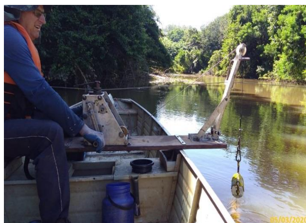
Foto 8 – Detalhe da campanha de amostragem de sedimentos no PHJ - 6°C. (Data: 05/03/20).
