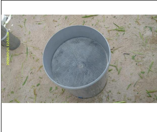
Foto 7 - Cone do Pluviômetro Limpo
