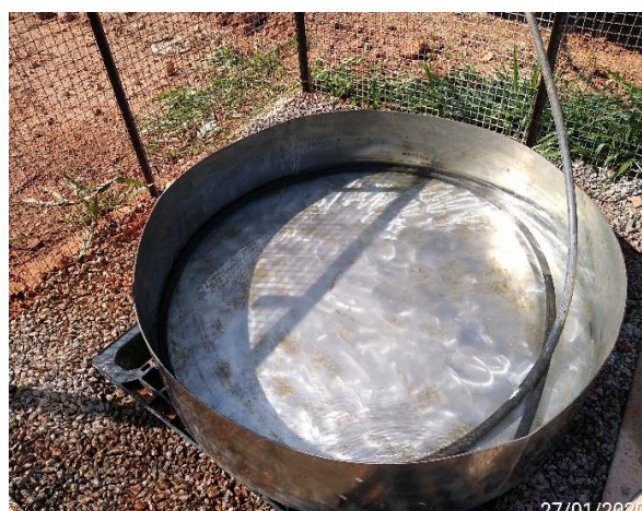
Foto 2 – Limpeza e troca de água do tanque do reservatório. (27/01/20).
