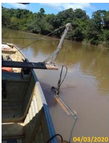
Foto 7 – Vista da coleta de sedimentos de leito no PHM - 7°C. (Data: 04/03/20).
