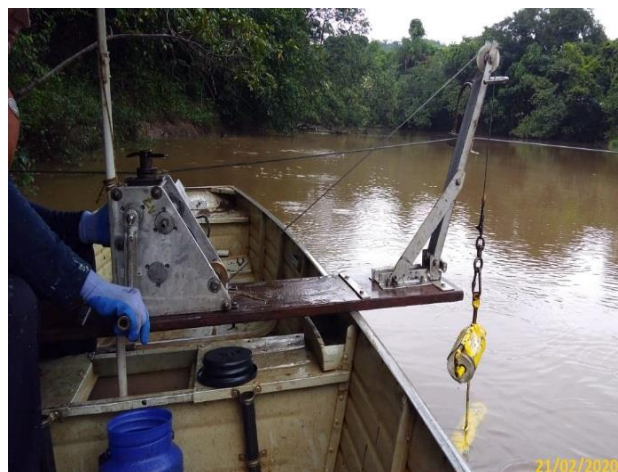
Foto 6 – Detalhe da coleta da amostragem de sedimentos no PHM - 6°C. (Data: 21/02/20).
