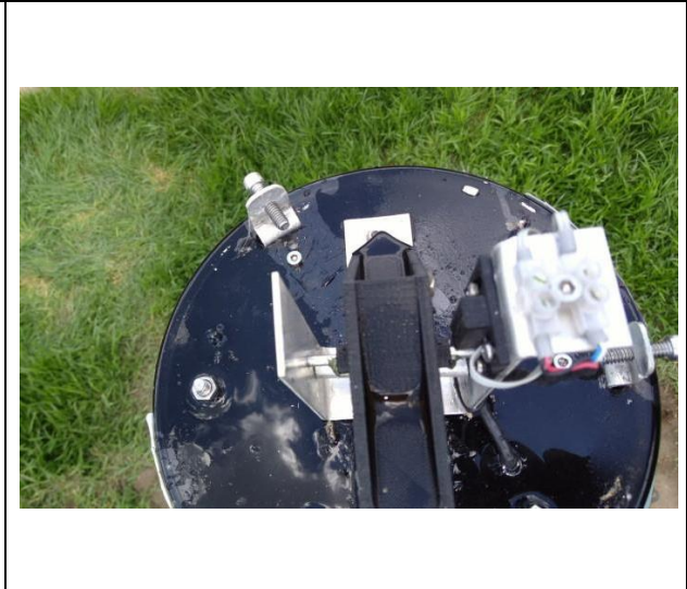
Foto 8 - Pluviômetro Aberto e Limpo
