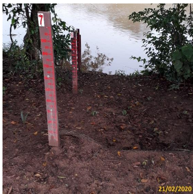
Foto 12 – Detalhe das réguas limnimétricas após a limpeza no PHM - 6°C (Data: 21/02/20).
