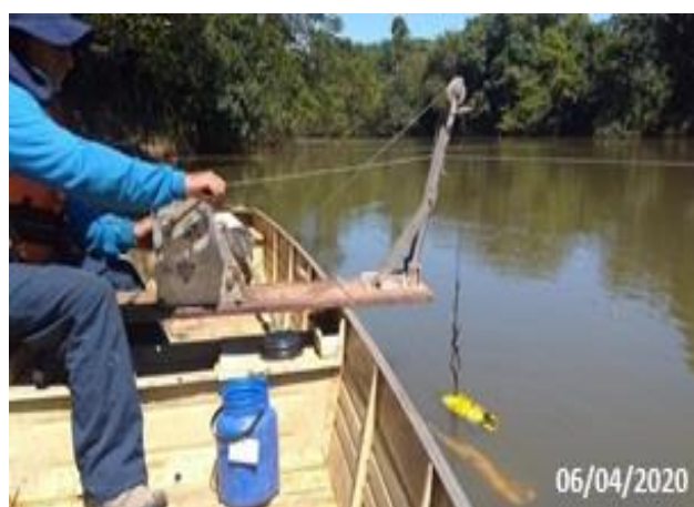
Foto 10 – Detalhe da Campanha de medição de sedimentos no PHM - 8°C. (Data: 06/04/20).
