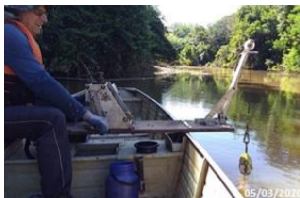
Foto 6 – Detalhe das atividades da medição de vazão no PHJ – 6ª Campanha (Data: 05/03/2020).
