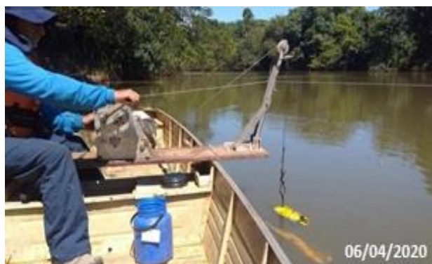
Foto 7 – Vista das atividades da medição de vazão no PHM - 8ª Campanha (Data: 06/04/2020).
