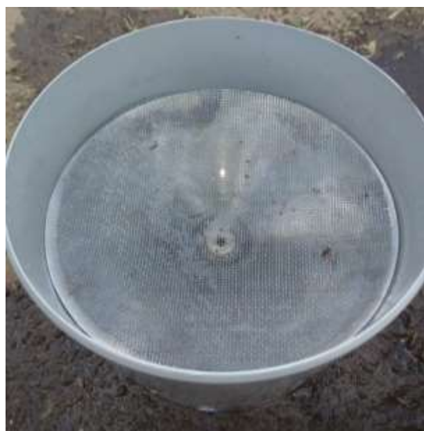
Foto 7 - Cone do Pluviômetro Limpo
