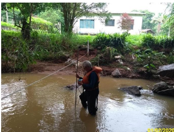
Foto 3 – Vista geral da coleta de sedimentos em suspensão no PSed - 5 a C. (Data: 01/02/20).
